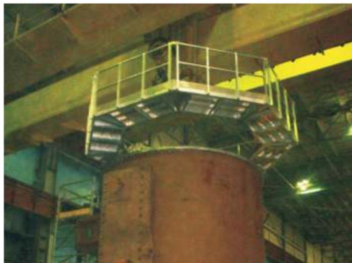
Универсальная технологическая площадка для обслуживания статоров, состоит из комплектующих, которые позволяют использовать технологическую площадку на всех типоразмерах статоров. Разработана и изготовлена для ОАО «СИЛОВЫЕ МАШИНЫ» Филиал «ЭЛЕКТРОСИЛА».
