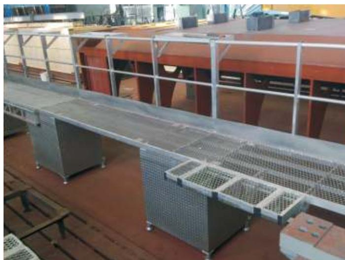
Технологические подмости разработаны и изготовлены для роторного участка ОАО «СИЛОВЫЕ МАШИНЫ» Филиал «ЭЛЕКТРОСИЛА».
